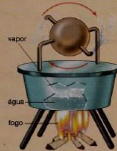
Fig. 12-26: Modelo da primeira máquina térmica, inventada por Heron no século I d.C.
